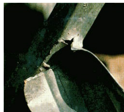
Abb. 10: Konstruktion aus Rechteckhohlprofilen, die im Zinkbad als Folge fehlender Bohrungen auseinander gerissen wurde
